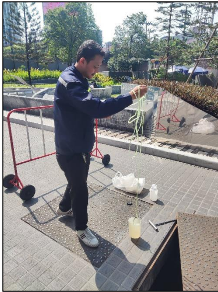
รูปที่ 3.5.1-2 การเก็บตัวอย่างคุณภาพน้ำทิ้ง
